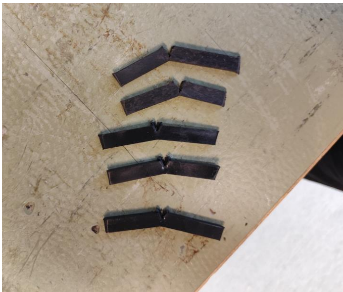
Kuva 3. Iskukokeen läpikäyneitä testikappaleita.
