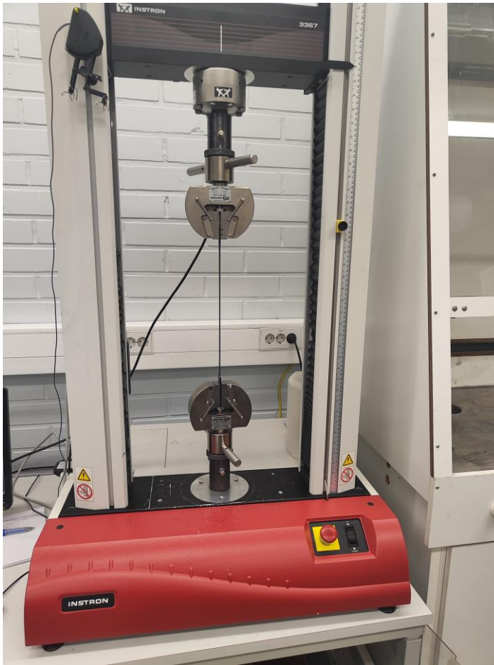
Kuva 2. Uusiomuovitestisauvan testausta Instron 3367 on aineenkoeistuslaitteistolla.
